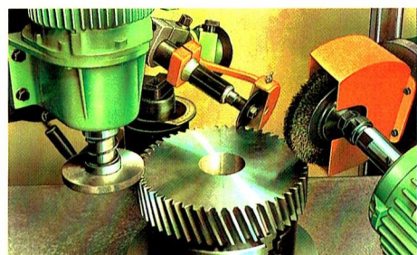
Vorentgraten - Schleifen - Bürsten Anfasung mit Linearzustellung
