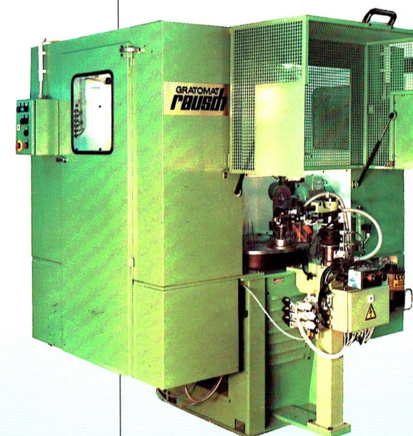
GRATOMAT® Maschine für Synchronringe MS 150/4 ① Anfassen Innen- zahnung ② Nachbürsten Sekundärgrat Autom. Beschickung über Doppelarm-Greifer.
